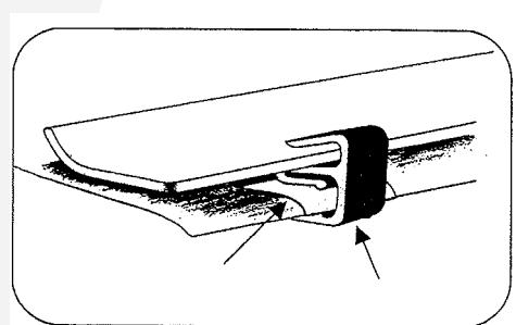
Klicka fast plastclipset med den plana delen mot huvskyddet (i profil syns en liten pigg, som skall fästas i huvskyddets borrade hål). Den tandade delen monteras runt motorhuven.
