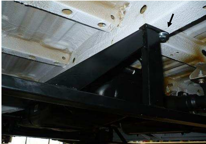
Alleen voor de lange Sprinter (4,32 wielbasis) Boor en gebruik kleine M10 plaat.
